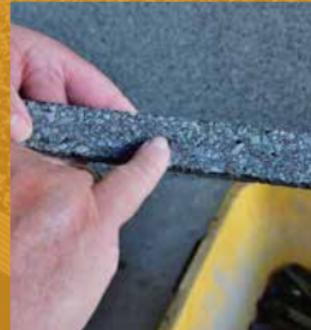
Bei der Herstellung von unseren Bodenplatten werden die abgeschnitten Ränder den Produktionsprozess wieder zugefügt. Somit entsteht bei der Fertigung kein Abfall.
